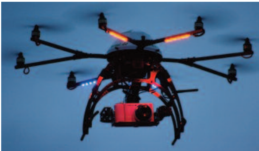
▲ Drohne mit acht Rotoren (Oktokopter), Android-Kamera und 3G Funk ▼ Cloud-Service
